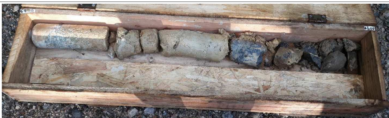
Figure 4 : SC16-5-20 (67 m – 68 m), faciès tectonisé gris, ensuite argileux, bleu marneux puis faciès noir fracturé reconnu comme ophite massive en toute fin de sondage.
