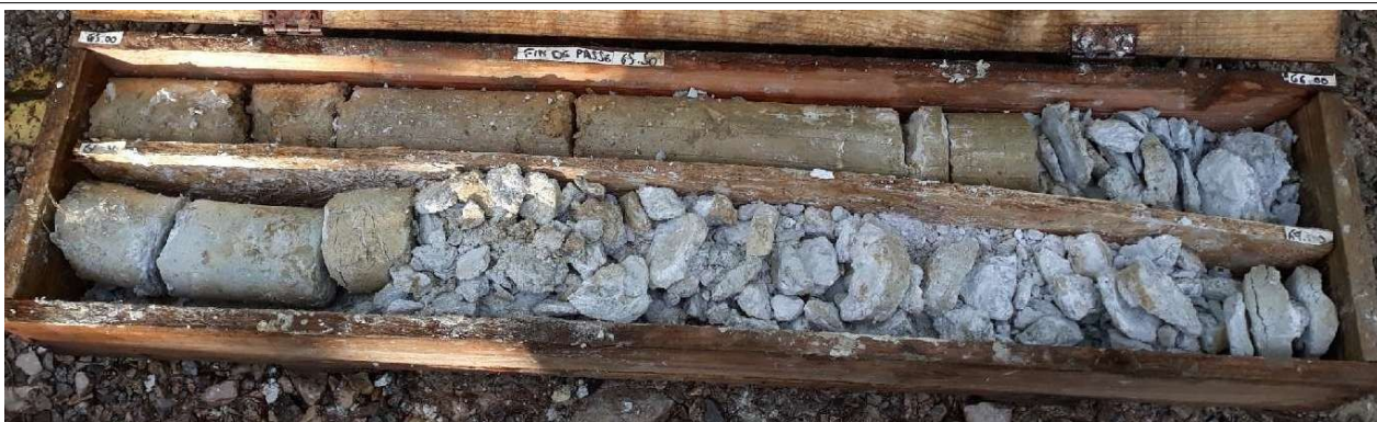
Figure 3 : SC16-5-20 (65 m – 67 m), faciès argileux puis tectonisé gris.
